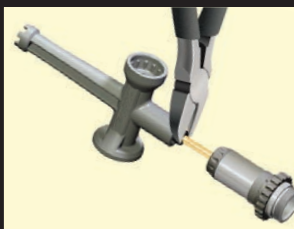
C. Entfernen/Montieren des Stabendes
