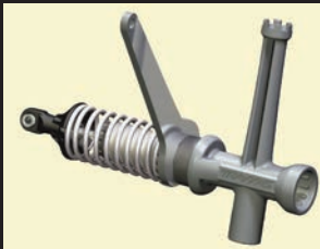
A. Anziehen/Lösen der oberen Abdeckung
