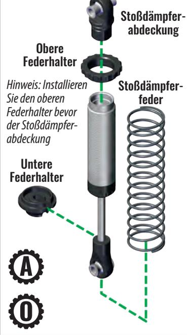
Betätigen Sie den Stoßdämpfer, um sicherzustellen, dass die Welle vollständig zusammen gedrückt wird. Falls nicht, ist zu viel Öl eingefüllt.
