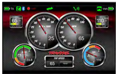
Das anpassbare Traxxas-Link-Armaturenbrett zeigt Daten für Drehzahl, Geschwindigkeit, Temperatur und Spannung in Echtzeit an.
