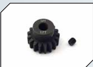
Art.Nr.: HSPX117 H-SPEED Motorritzel 17Z Modul 1.0 für 5mm Welle
