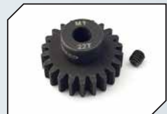
Art.Nr.: HSPX122 H-SPEED Motorritzel 22Z Modul 1.0 für 5mm Welle
