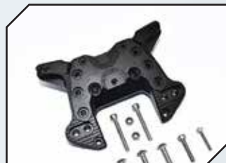
Art.Nr.: GPMMAKX028BK GPM Aluminium Dämpfersteher vorn schwarz
