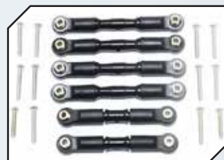
Art.Nr.: GPMAG160BKBEK GPM Aluminium Spurstangen-Set m. Kugelfannern schwarz (6 Stk.)
