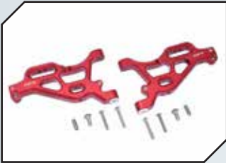
Art.Nr.: GPMMAF055R GPM Aluminium Querlenker oben hinten rot
