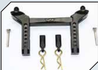
Art.Nr.: GPMTRX4201FBK GPM Aluminium Karosseriesteher vorn schwarz
